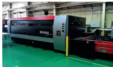
3軸リニアドライブ・ファイバーレーザーマシン Three-axis linear drive fiber laser machine
